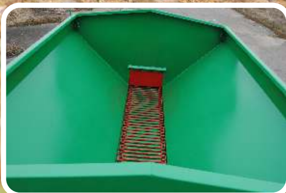
Skosy zbiornika ograniczające przyleganie nawet mokrego materiału.
