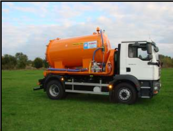
Kontener asenizacyjny Typ KA 6700 o poj. 6700 L wyposażony w otwieraną tylną dennicę, przystosowany do hakowego systemu załadowniczego.
