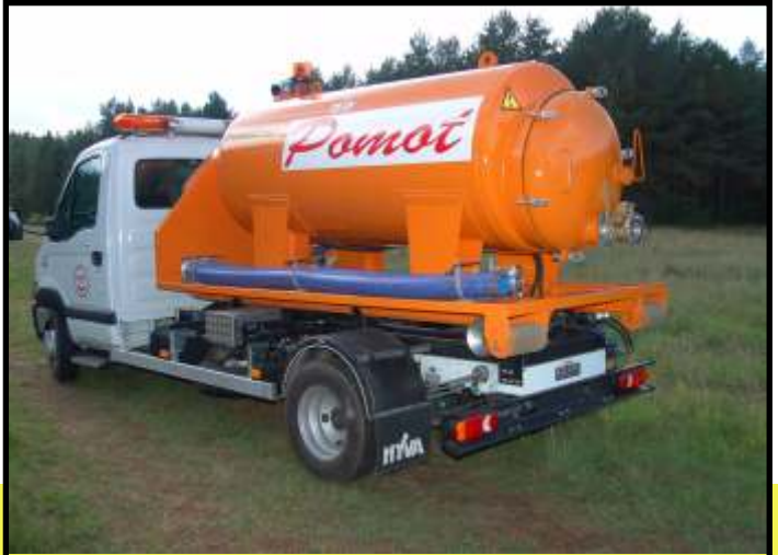
Kontener asenizacyjny Typ KA 2500 o poj. 2500 L przystosowany do hakowego systemu załadunkowego z tylnym włazem o średnicy 900 mm
