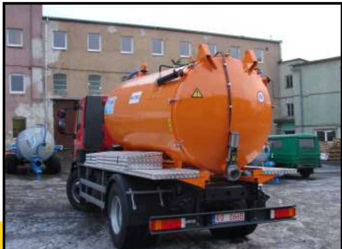
Zabudowa asenizacyjna typ ZA 7500 o poj. 7500 L wyposażona w hydraulicznie otwieraną dennicę
