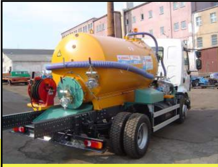
Zabudowa asenizacyjna Typ KA 4500 K o poj. 4500 L z urządzeniem do czyszczenia kanalizacji
