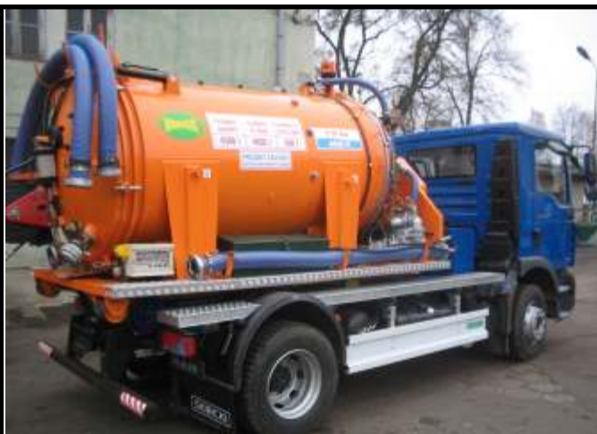
Kontener asenizacyjny Typ KA 4500 K o poj. 4500 L wyposażony w urządzenie do czyszczenia kanalizacji, hydraulicznie otwieraną całkowicie tylną dennicę
