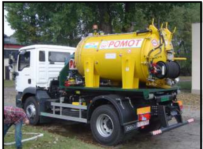
Kontener asenizacyjny Typ KA 4500 K o poj. 4500 L z urządzeniem do czyszczenia kanalizacji, całkowicie otwieraną hydraulicznie tylną dennicę sterowaną hydraulicznie zasuwę spustową.
