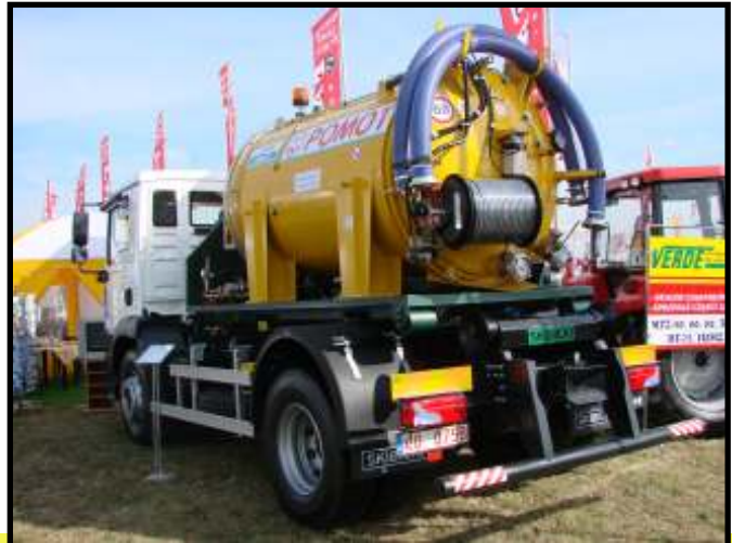
Kontener asenizacyjny Typ KA 4500 K o poj. 4500 L z urządzeniem do czyszczenia kanalizacji przystosowany do hakowego i bramowego systemu załadowniczego z otwieraną hydraulicznie zasuwę spustową i tylną dennicę
