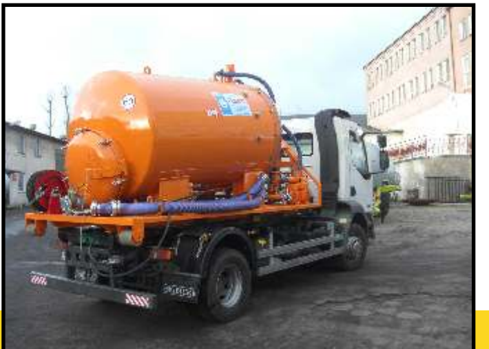
Kontener asenizacyjny Typ KA 8000 K o poj. 8000L z urządzeniem do czyszczenia kanalizacji.
