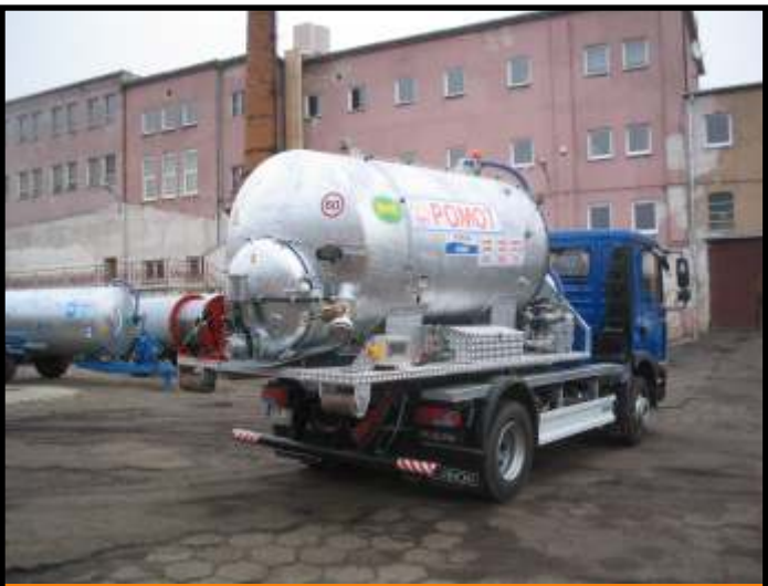
Kontener asenizacyjny Typ KA 4500 K o poj. 4500 L z urządzeniem do czyszczenia kanalizacji
