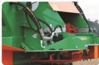
Hydraulische Breiteneinstellsystem an Computer anschließbar
