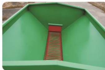
Steile, polyurethanbeschichtete Behälterwände garantieren nachrutschen vom Streuematerial in jedem Gelände.
