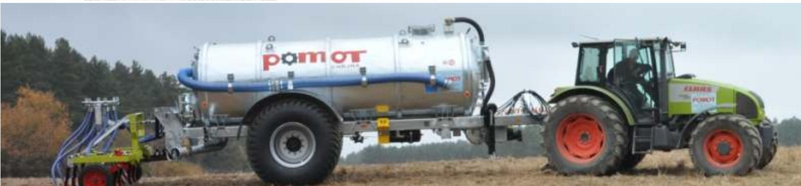
Bei geplantem Anbau von Aggregaten ist Konstruktion mit verlängerte Rahmen sinnvoll
